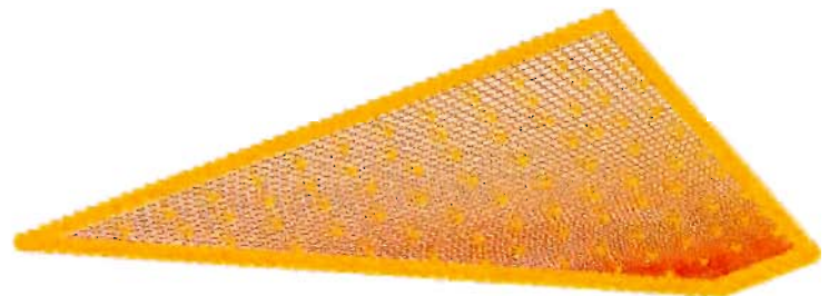
Bild 7: Darstellung des ausgekleideten Sohlbereiches im Verschneidungsbereich zwischen zwei Großrohren Fig. 7: View of the lined shaft-bottom zone in the area of intersection of two large-caliber pipes
