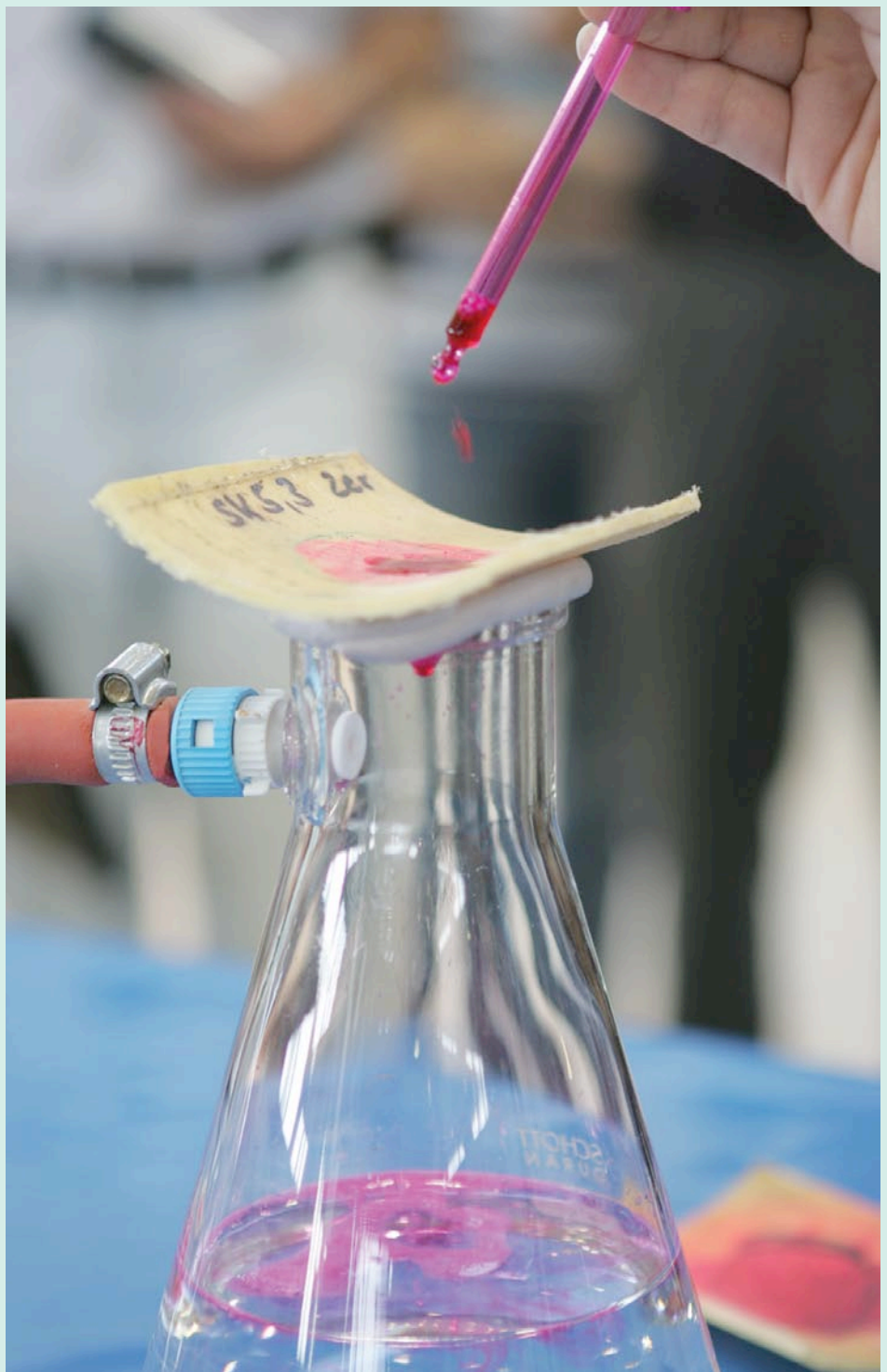
Wasser (rot) tropft durch: Liner undicht!
