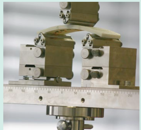
Linerprobe im Dreipunkt-Biegeversuch
