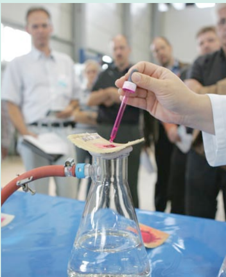
Dichtheitsprüfung nach APS-Prüfrichtlinie im IKT-Labor
